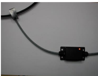
Bild 2: LED rot = Lichtbogen-Erkennung oder Fehler in Schaltung
